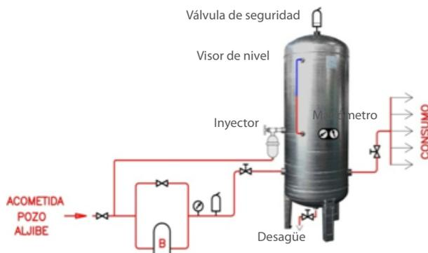
En el caso de ser instalado como depósito auxiliar presurizable en la **ASPIRACIÓN** de las bombas, el volumen total del depósito (aire y agua) en litros, debe ser como mínimo el obtenido al multiplicar el coeficiente según el caudal instalado por el número de suministros a viviendas y/o locales, según la siguiente tabla:
